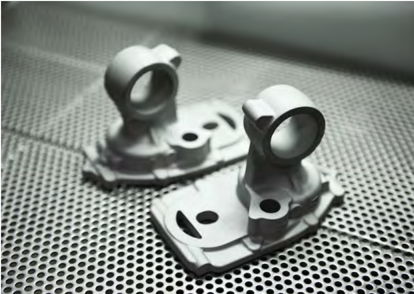
Bild 3: Neue Bauteile können bei Franken Guss zunächst additiv als Prototypen gefertigt werden, bevor sie in Serie gehen.
