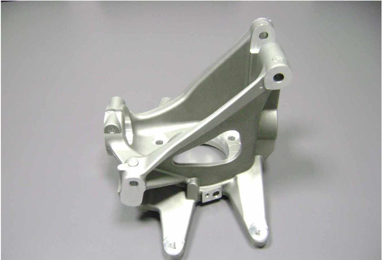
Leichtbau am Beispiel eines Pkw-Radträgers, Werkstoff: EN AC-AI Si10Mg T6.
